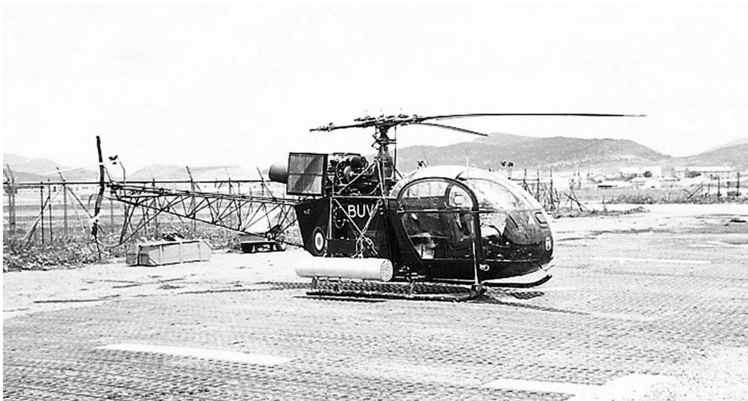
Alouette II du PMAH de la 21 e DI, armée de roquettes SNEB, et équipée de filtres anti-sable, à Batna (photo Norbert Kugel).
